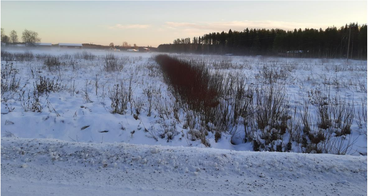
Kuva 7 Kosteikon paikka on kesantopeltoa. Rauhalantien tierumpu on syvällä, mutta maasto laskee loivasti Pylväsojan suuntaan. Kosteikko on mitoitettava siten, että vesi ei haittaa Rauhalantien kuivatusta.
